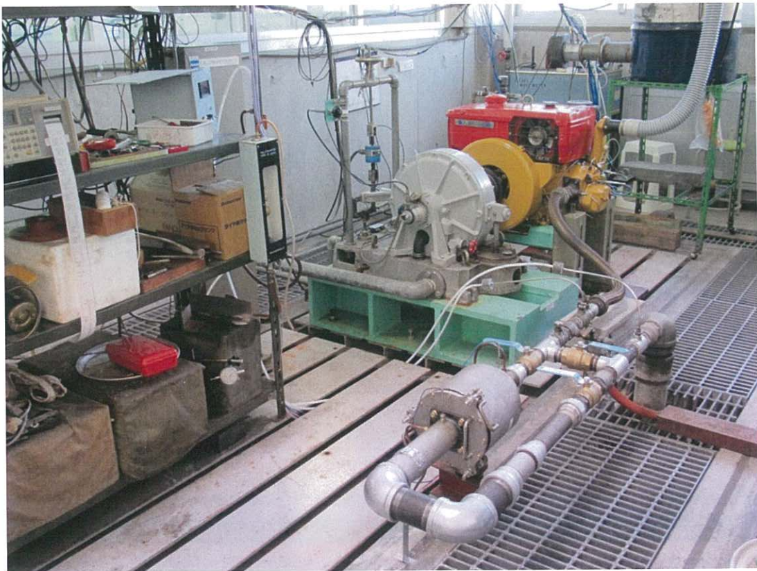
Fig. 1 DPF 目詰まり性能実験装置
