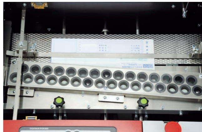
アライニング装置による軌道修正機能により、処理のロス率を低減。
