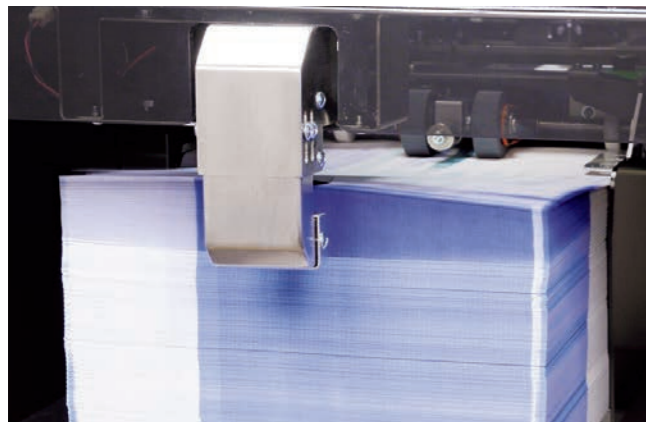
給紙部の送風装置（ブローア）により、給紙の安定性がアップ。
