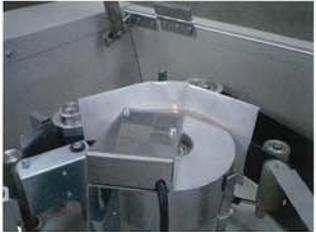
封筒検査部ではフラップの封緘具合を検査します。フラップには負荷を与えない非接触方式で検査をおこないます。オプションの宛名検査装置を付加すると、フラップと宛名の検査が同時に行えます。
