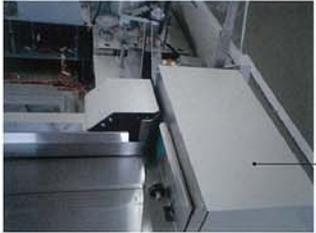
最大4mmの厚みの封筒まで対応します。ランダム厚みの封筒を混在してセットすることも可能です。
