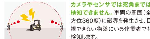
カメラやセンサでは死角までは検知できません。車両の周囲(全方位360度)に磁界を発生させ、目視できない物陰にいる作業者でも検知します。
